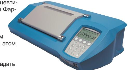
При использовании на производстве сахара ADP 440 может быть центральным узлом системы контроля чистоты, работая в режиме сахариметра. При контроле чистоты ADP440 рассчитывает "чистоту сахара", автоматически получая результаты в °Brix с рефрактометра серии RFM300+ или RFM900.
