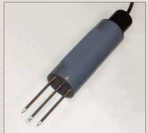
Датчик для измерения влажности почвы
