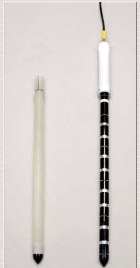
Профильный датчик и тонкостенная трубка
