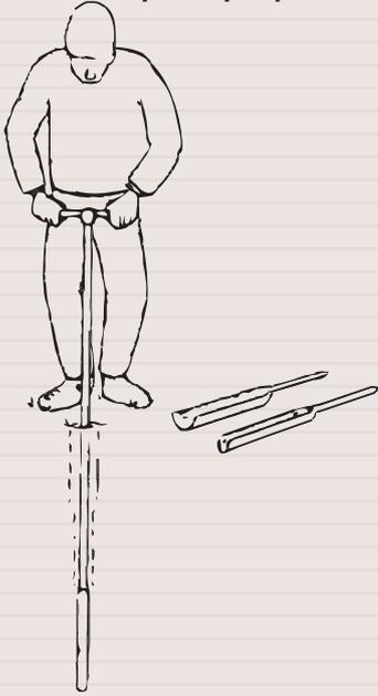
**С помощью ловителя камней камень извлекается из скважины.**
