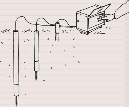
**Датчик в профильном исполнении устанавливается в тонкостенную трубку, показания снимают измерителем.**
