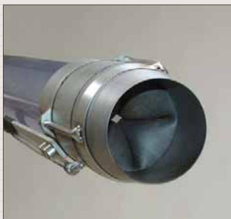
Режущая головка с надутой мембраной
