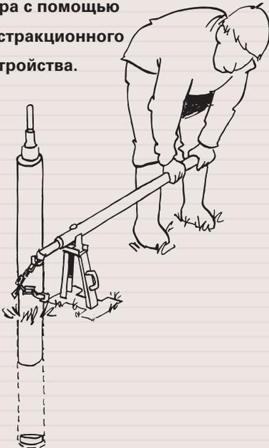
С помощью цилиндрического бура Вы можете отбирать почву с сохранением ее структуры на глубине до 1 м. Это позволяет быстро получить описание почвенного профиля, корневой системы и т.д. Широко применяется в с/х.
