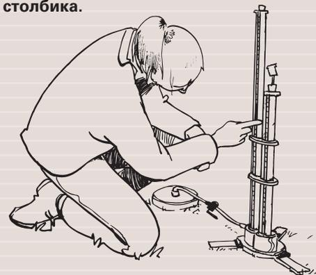
**Тензионный инфильтрометр подсоединен к даталоггеру.**
