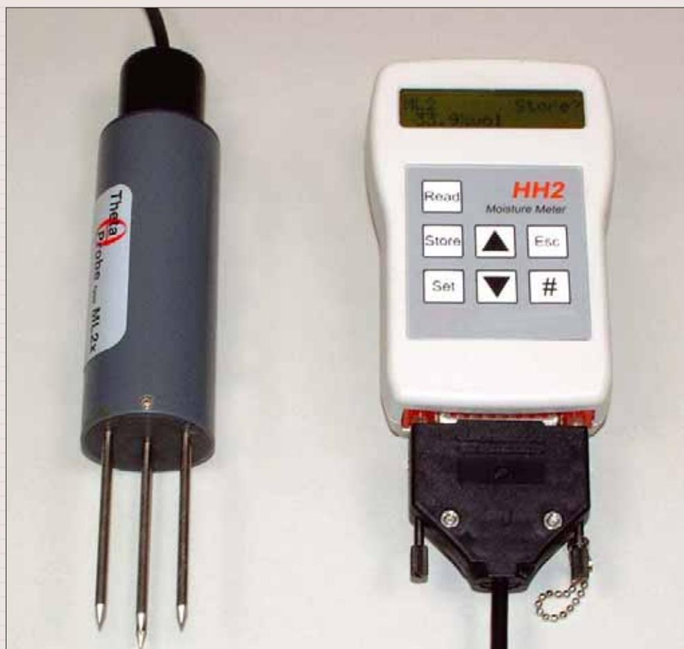
Измеритель влажности с датчиком влажности Thetaprobe
