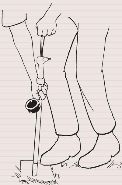
**Отверстие для тензиометра готовят с помощью бура.**
