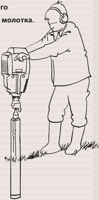
**Извлечение цилиндрического бура с помощью экстракционного устройства.**
