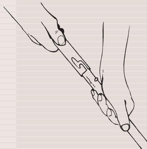
**Прочность резьбового соединения обеспечивается использованием гаечного ключа.**
