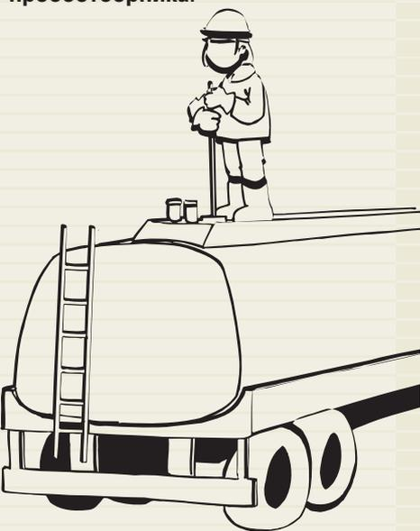
**При соприкосновении с дном резервуара пробоотборник открывается и наполняется.**
