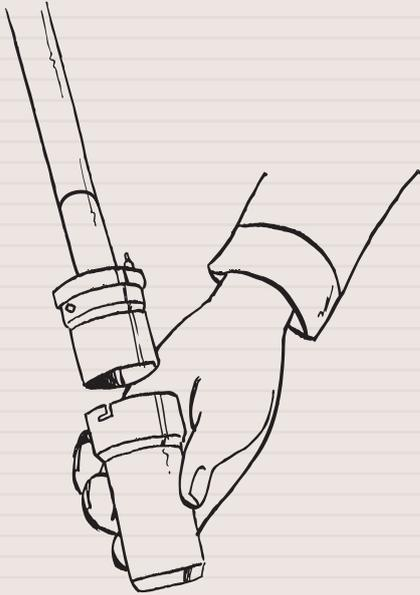
Устройство для забивания кольца и направляющий цилиндр.
