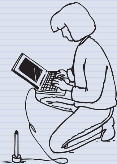
**БароДайвер** предназначен для измерения барометрического давления. Данные измерений снимаются и обрабатываются в специальной программе. БароДайвер нужен для компенсации показаний, полученных с помощью других типов дайверов.
